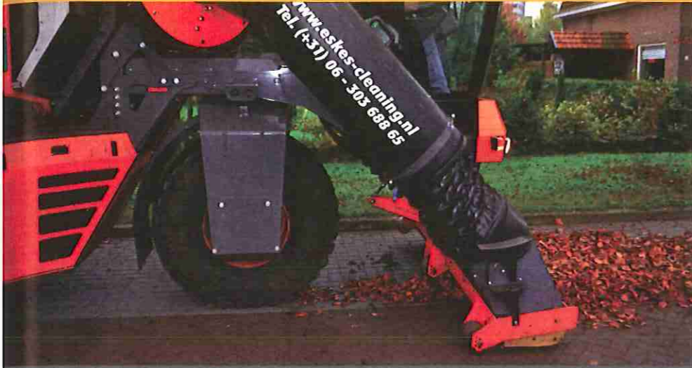
De exhausters zorgen voor een luchtsnelheid van 200 km/h in de pijpen
